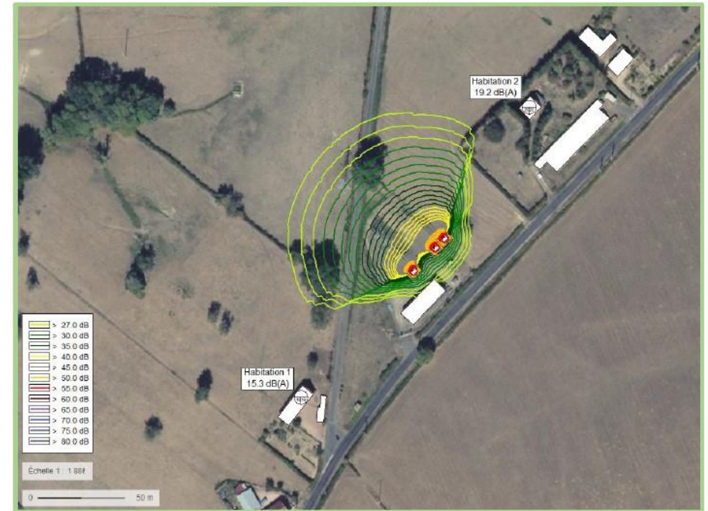
FIGURE 45 : AJOUT DES TRANSFORMATEURS ET MURS DE PROTECTION
